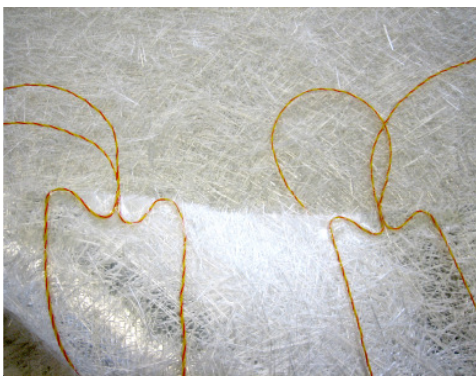
Doppelte Drahtschleifen aus Kupfer mit Kunststoffummantelung werden vor dem Schleudervorgang gleichmäßig auf den GFK-Matten fixiert.
